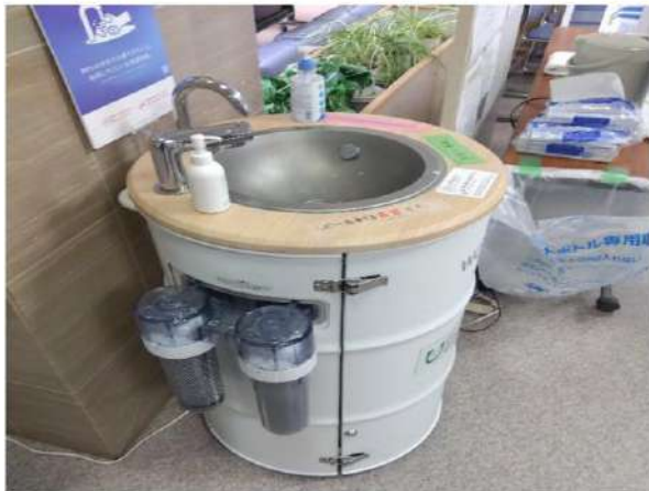
水循環型手洗スタンド（志賀町）
