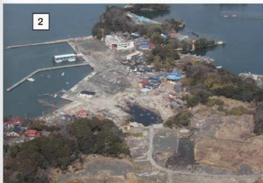
2・野々島：写真下の海水浴場側から写真上の集落方向に向け津波が襲来。中央部分にあった道路は途中で滅失、家屋も流出、全壊多数。写真の中央部には、巨大な窪地が発生した。
